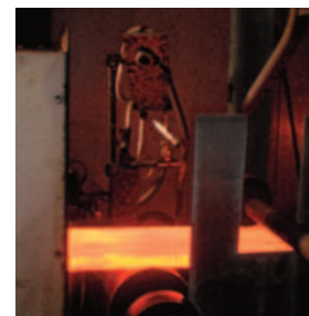
Metis MS09 mit Schwenkspiegel SC10 und Kühlplatte Messung von Langmaterial
