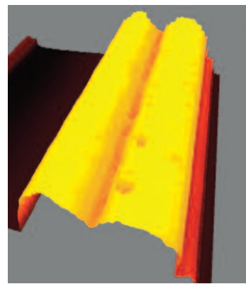
Seiten- und Oberfläche eines Knüppels in der 3-D Darstellung
