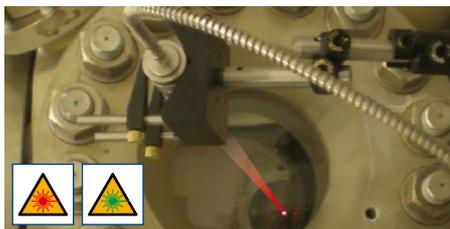
Das **Durchblickvisier** wird (seitenrichtig) direkt in das Objektiv eingespiegelt, so dass das Messobjekt visuell erfasst werden kann. Bei stationären Geräten ist der Fokuspunkt am scharf eingestellten Okular gefunden, Handgeräte zeigen die Messfeldgröße.
