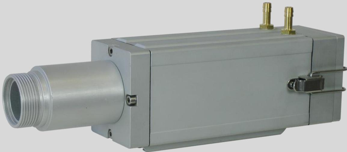
Das Kühlgehäuse wird eingesetzt, um Pyrometer außerhalb ihrer zulässigen Umgebungstemperatur bei bis zu 250°C zu betreiben. Als Kühlmedium kann Wasser oder Luft verwendet werden, wobei die maximale Kühlleistung nur mit Wasser erzielt wird.
