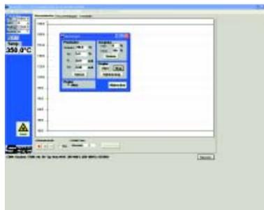
Die Funktion „Temperatur simulieren“ erlaubt es am Analogausgang des Pyrometers einen beliebigen Temperaturwert innerhalb des Messbereichs als 0/4-20mA Signal auszugeben und damit die nachgeschaltete Peripherie zu überprüfen.
